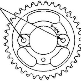
Al instalar esta catarina de árbol de levas en motores Cadillac V-8 429 cid se requiere de un cambio en los pernos de montaje de la catarina.
